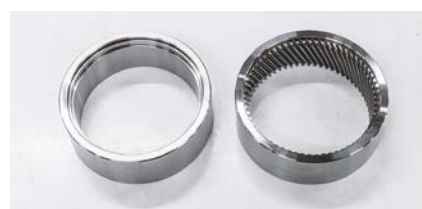
[Z lewej] Komponent przed obróbką [Z prawej] Ten sam komponent po obróbce przeciąganiem
